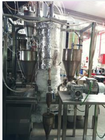
Oxicombustión – 3 kW coal
